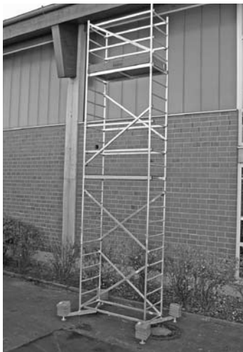
Grundgerüst mit erster und zweiter Aufstockung
