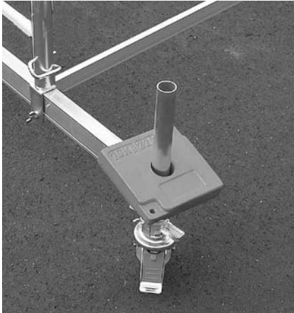
Ballastierung der Traversen
